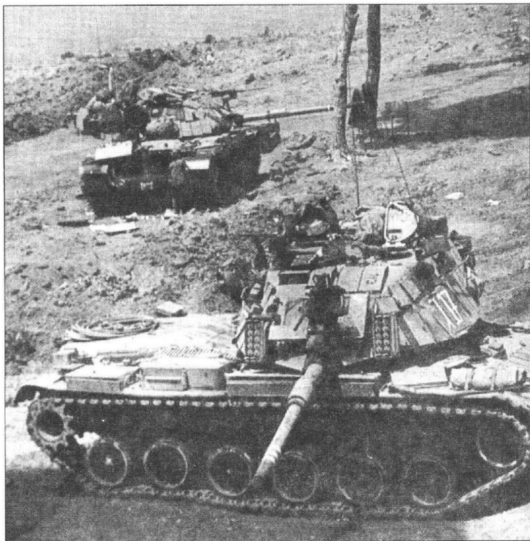
Два танка «Mag'ash» заняли оборону в районе Эйн-Дары на шоссе Бейрут-Дамаск, 22 июня 1982 года. Отлично видна реактивная броня типа «Blazer».
