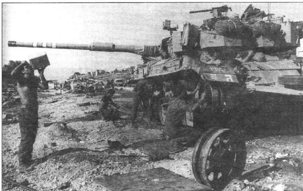
Модернизированный «Centurion» ремонтируется в полевых условиях, район Дамура. Обратите внимание на навесную реактивную броню и дымовые шапки. На крыле на иврите написано «mahatz» - «сила». Буква «gimel», расположенная чуть ниже, означает 3-й батальон.
