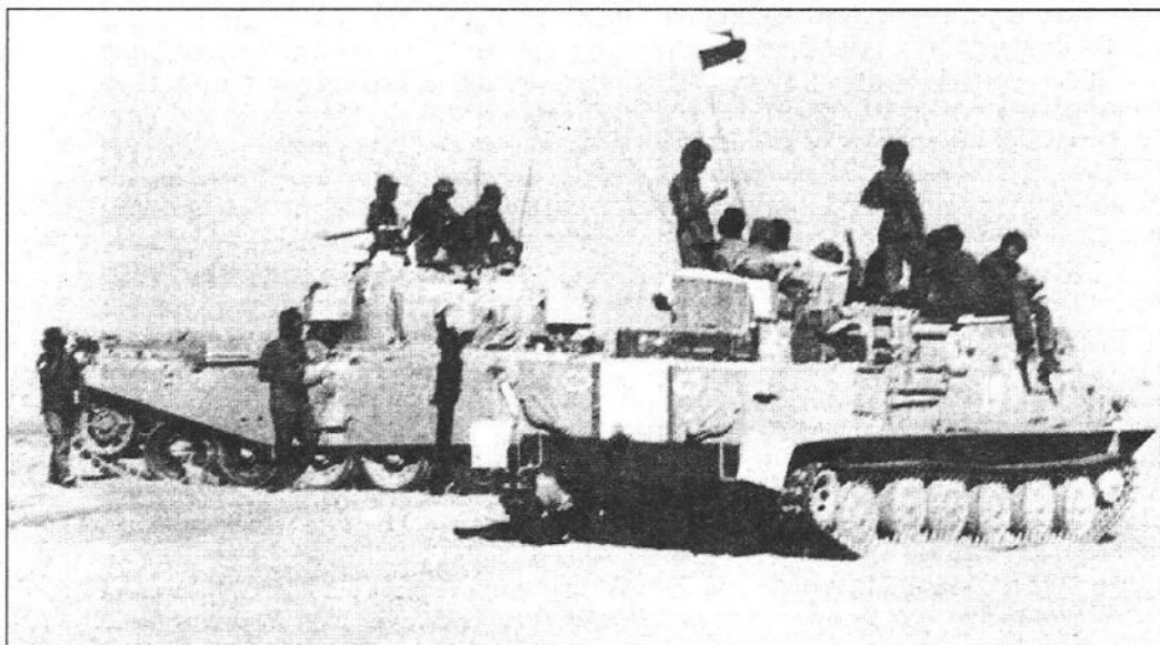
Разведывательный ОТ-62 на службе в АОИ. Обратите внимание на батальонный флаг, а также на белую полосу на кормовой броне. Эта полоса позволяла механикам-водителям держать дистанцию во время ночных передвижений.
