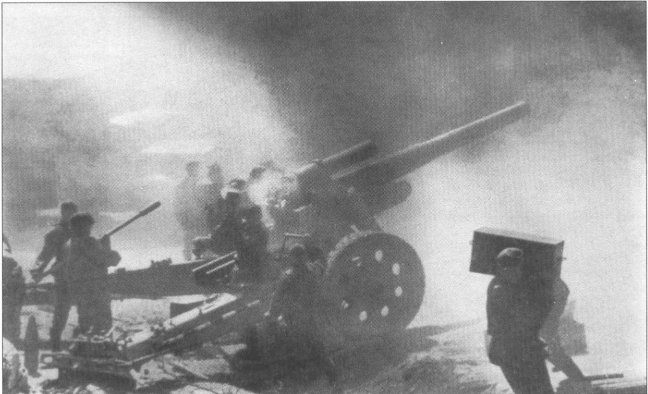
150-мм гаубица войск СС ведет огонь с закрытой позиции. Находящийся на передовой наблюдатель корректирует огонь. Артиллерист слева держит в руке банник.
